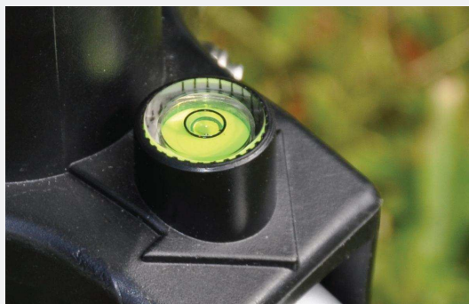
Wasserwaage - zur Ausrichtung des Stativs und der Sat-Antenne
